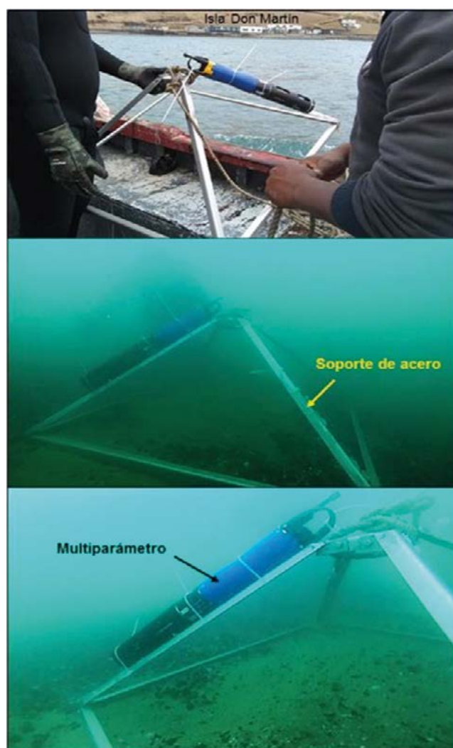
Figura 3.- Instalación de sonda multiparámetro sujeta a estructura metálica en el fondo marino, isla Don Martín
