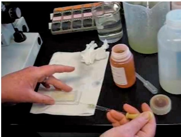
Figura 10.- Llenado de la cámara de Sedgewick Rafter
