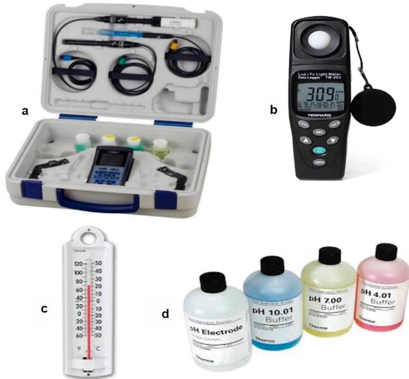
Figura 12.- Multiparámetro WTW (a), Luxómetro (b), termómetro ambiental (c) y pack de buffer (d)
