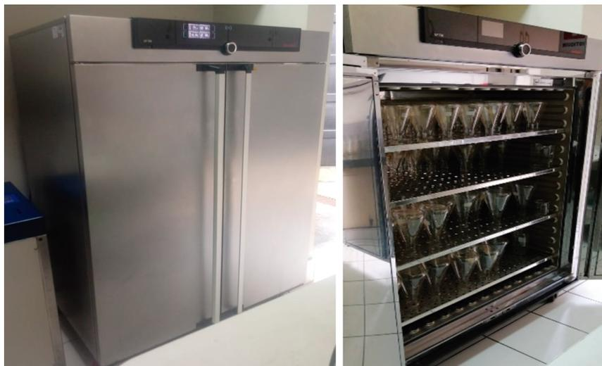
Figura 7. Estufa vertical de 750 L de capacidad, para esterilización de probetas, matraces, beakers, tapones u otros materiales resistentes al calor
