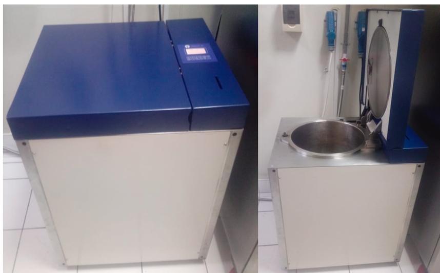
Figura 8.- Autoclave vertical, equipo empleado para la esterilización del medio de cultivo, del agua de mar y agua destilada
