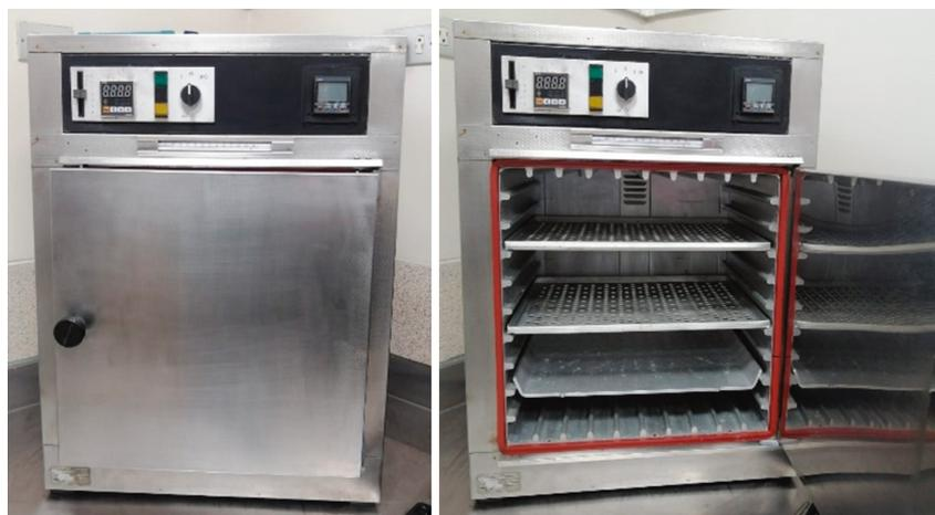
Figura 6.- Estufa de 80 L para esterilizar materiales pequeños como pipetas Pasteur, viales y otros
