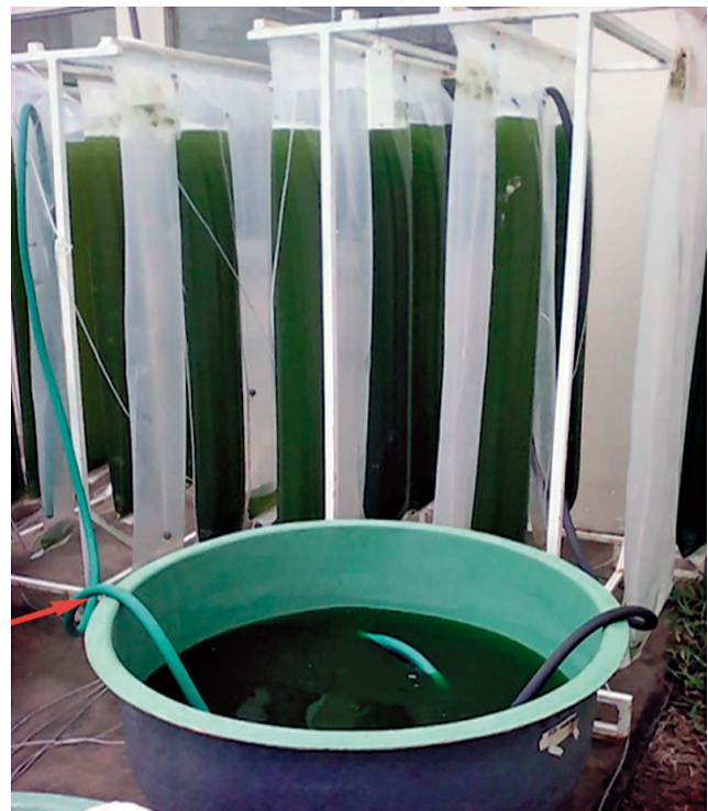
Figura 9.- Disposición final de sistema de recirculación por bomba de succión. (a) Manguera de retorno de cultivo, (b) manguera de succión centrifugación
