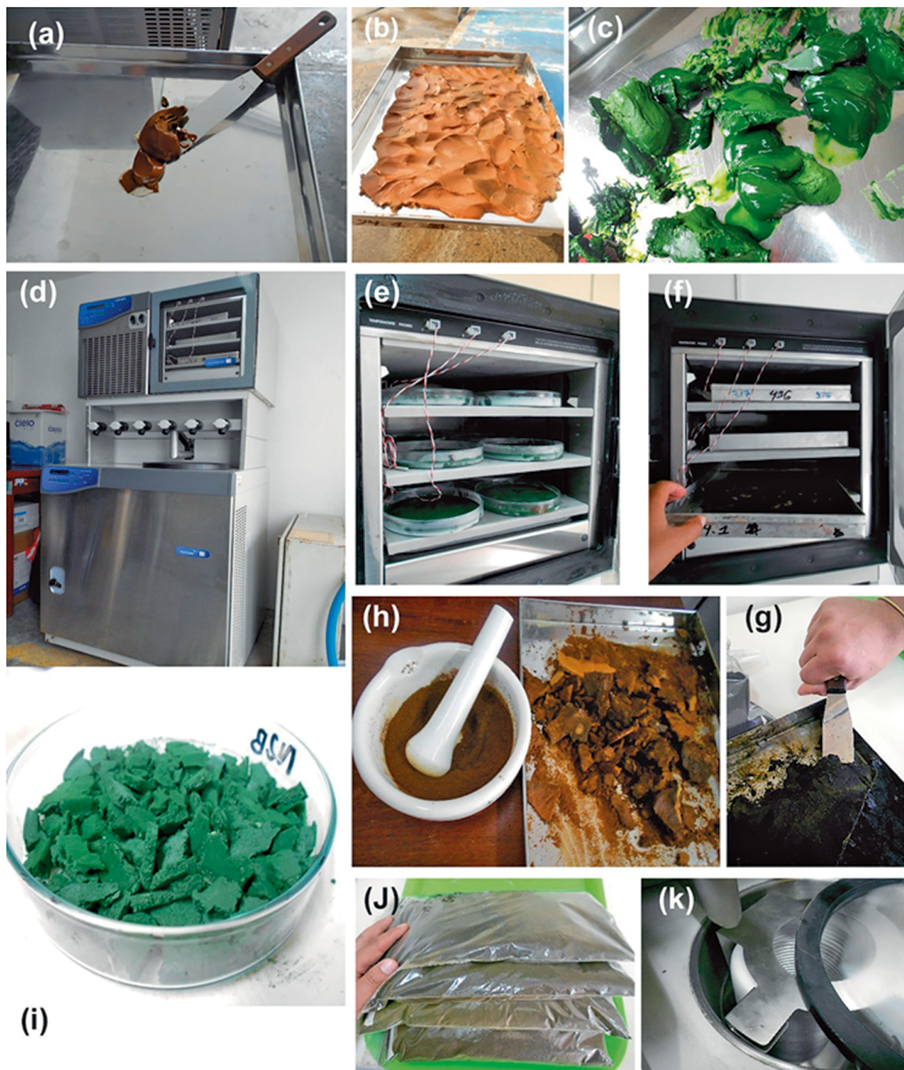
Figura 21.- a) Biomasa microalgal esparciéndose en bandeja de acero inox.; b, c) biomasa húmeda esparcida de 2 microalgas diferentes, d) equipo realizando proceso de liofilización (flecha roja señala la posición final de llave central, indica que vacío se realiza en todo el equipo), e) muestras en placas Petri de 150x25 mm, f, g) muestras liofilizadas en bandejas de acero inox de 38 x36 x3 cm, h) homogenización mecánica de muestras, i) muestras liofilizadas en placas Petri de 150x25 mm, j) muestras embolsadas y rotuladas para análisis o almacenamiento, k) colector abierto para descongelamiento del agua que fue recolectado durante el proceso de liofilización (flecha roja señala el agua captada de las muestras en estado sólido)
