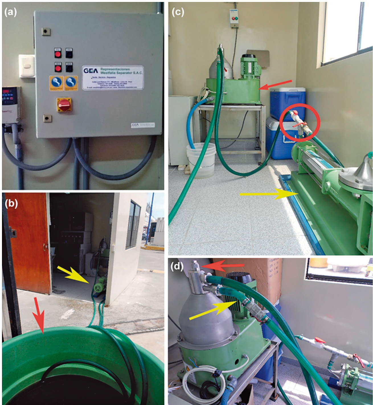
Figura 15.- Proceso de centrifugación: a) a la izquierda panel electrónico de la centrífuga, a la derecha el variador de velocidad A. Bardley, b) sistema de recirculación de cultivo, bomba de succión Nemo® (flecha amarilla), tanque de acopio de cultivo (flecha roja), c) disposición final de sistema de centrifugación, centrífuga de limpieza manual (flecha roja), bomba de succión (flecha amarilla), posición final de llaves de paso del sistema de recirculación e ingreso de cultivo hacia centrífuga (círculo rojo); d) posición final de mangueras de ingreso (flecha roja) y mangueras de salida después de centrifugación (flecha amarilla)
