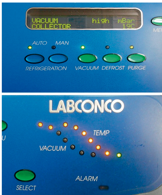
Figura 20.- Tablero de mando del Free zone, del Liofilizador
