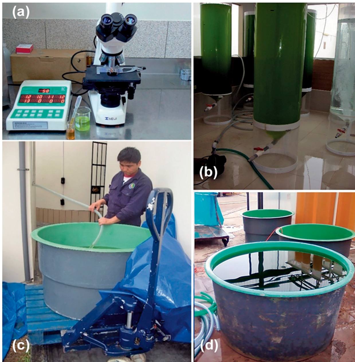
Figura 4.- a) Observación microscópica y determinación de densidad celular, b) biorreactores cilindro cónicos con inóculo; c) traslado de inóculo; d) acopio de microalgas, proveniente de la Sala de microalgas (Cultivos intermedios) en el Laboratorio de invernadero y sala de procesos
