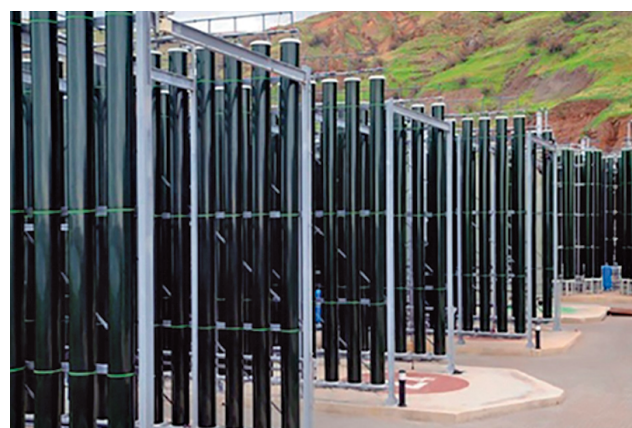
Figura 1.- Sistemas de cultivos cerrados: biorreactor tubular horizontal y biorreactor tubular vertical
