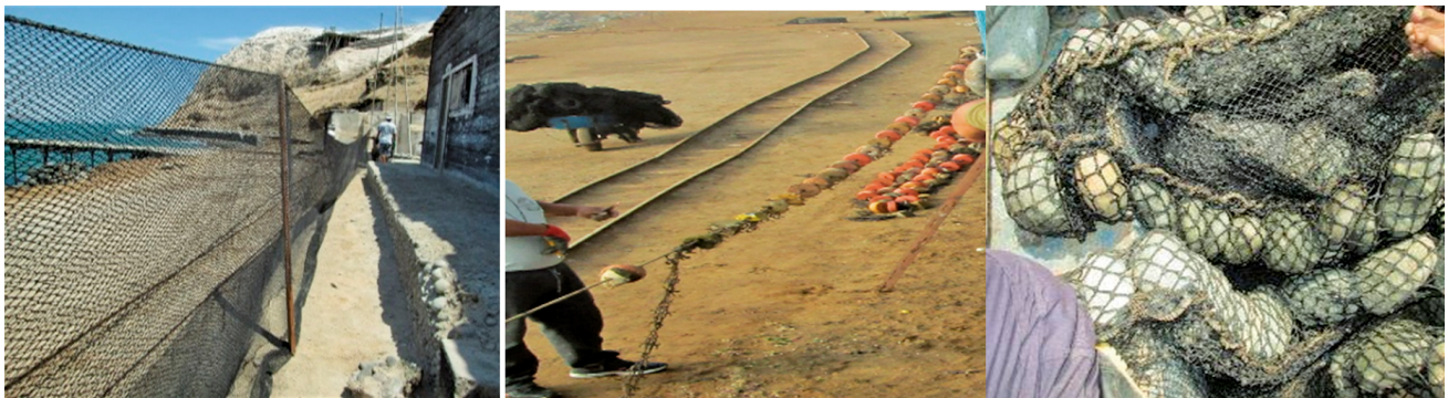
Figura 13.- Armado de la relinga de corcho y fondo
