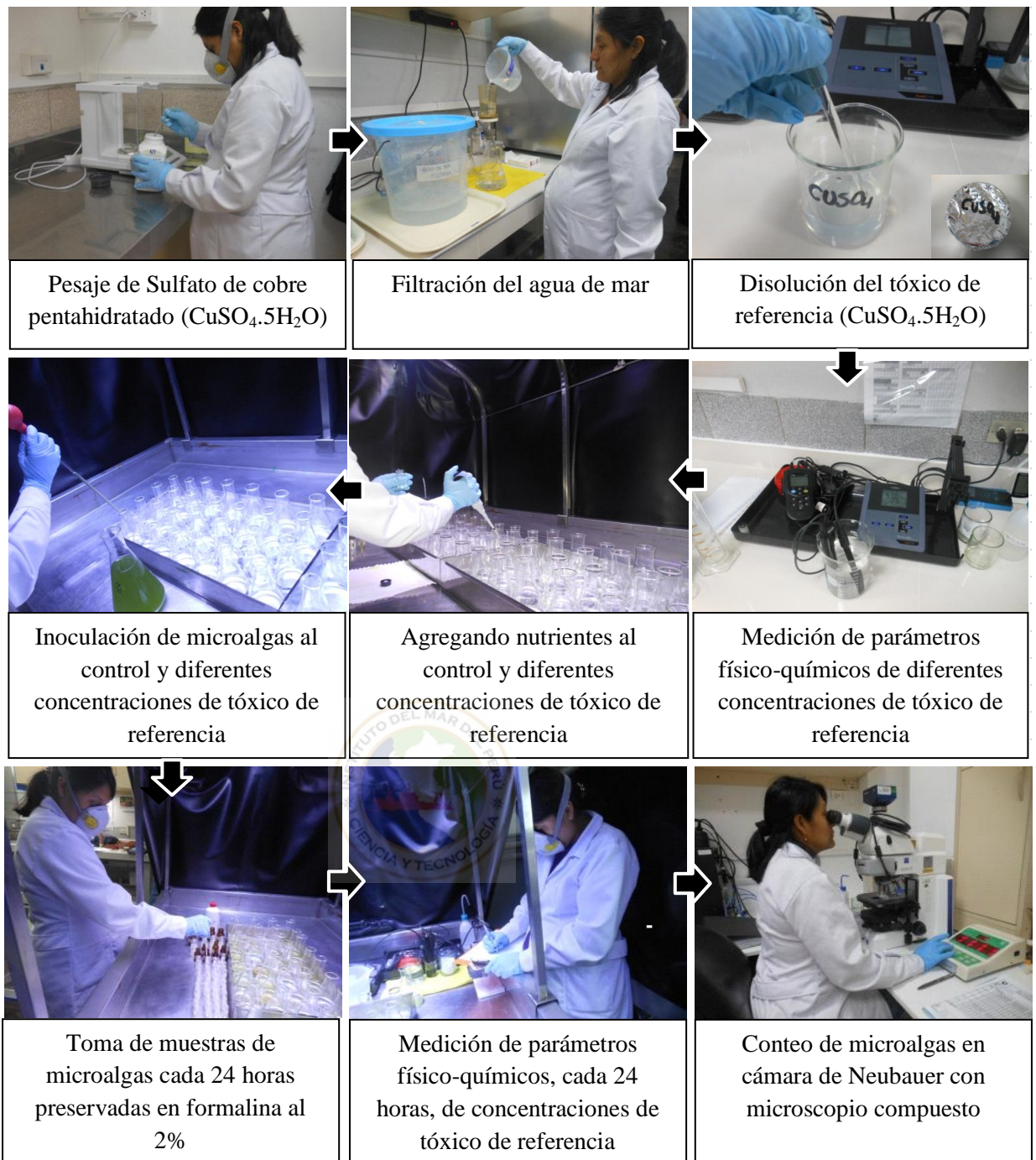
Figura 7. Preparación del control positivo con sulfato de cobre pentahidratado para ensayos de toxicidad con microalgas marinas Isochrysis galbana y Nannochloropsis oceanica .
