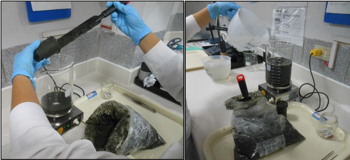
Anexo 8. Preparación del elutriado del sedimento.
