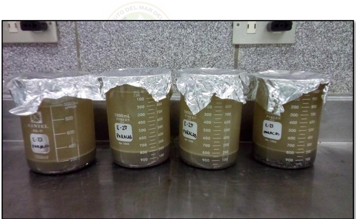
Anexo 10. Proceso de sedimentación del elutriado.
