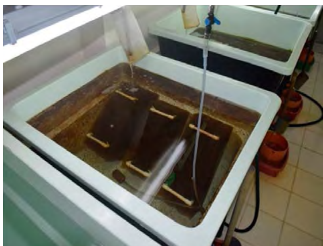
Figura 12.- Inyección de aire moderado en tanques con set de placas
