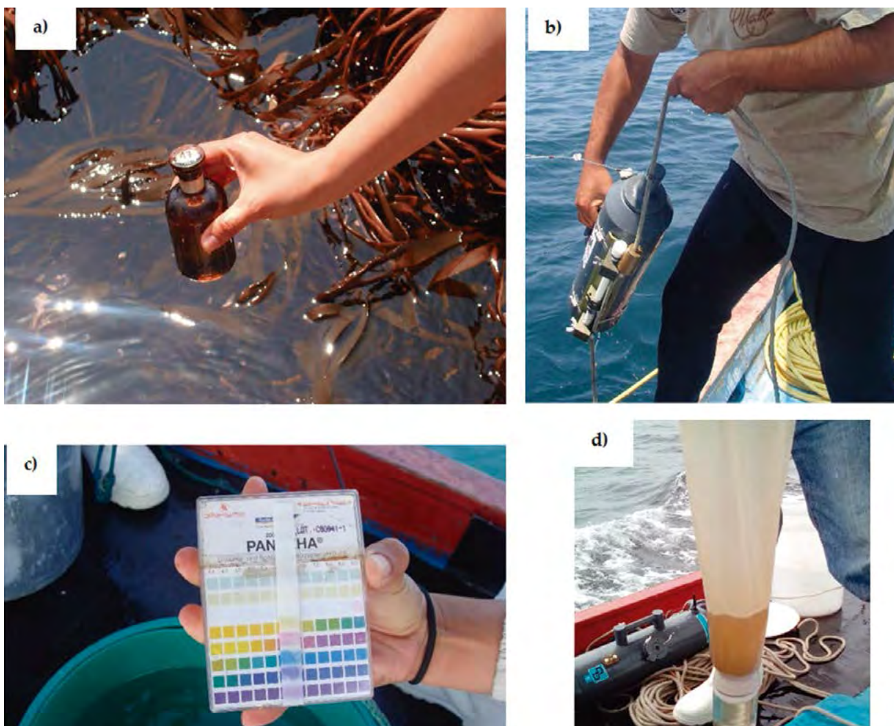
Figura 41.- Recolección de muestras de agua para determinar: a) oxígeno disuelto, b) salinidad y temperatura con botella Niskin, c) registro de pH, d) plancton
