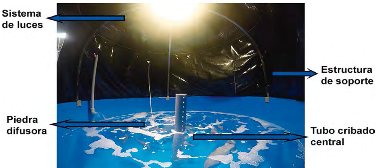
Figura 6.- Parte interna del tanque de cultivo, se observa la estructura de soporte de acero inoxidable, tubo cribado central, piedra difusora y sistema de luces interior
