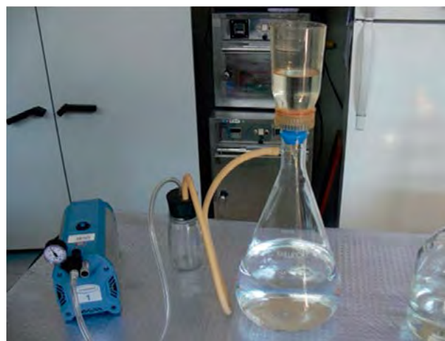
Figura 5.- Equipo de filtración
