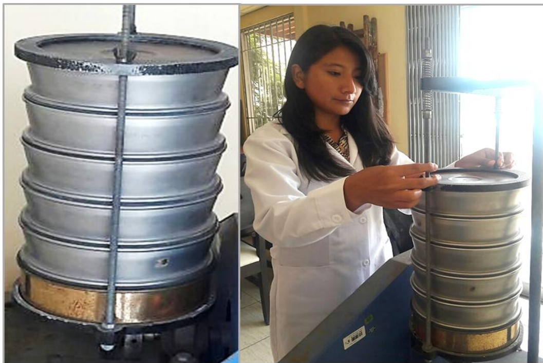
Figura 5.- Tamices y tamizado de sedimento para análisis granulométrico, Junco Marino y Cerro Negro, 2017.
