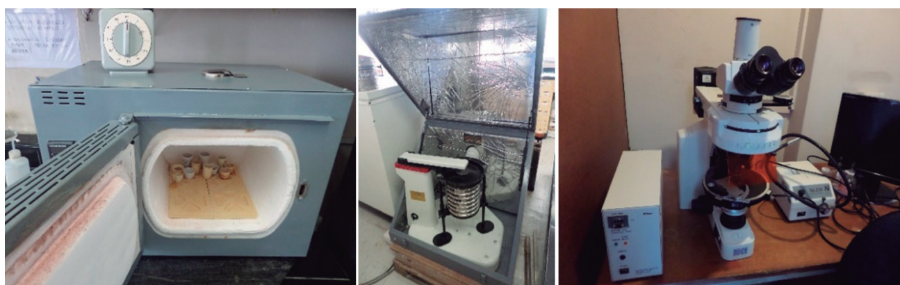
Figura 3.- Equipos de análisis en laboratorio. a) Mufla eléctrica Thermolyne, b) Tamizador eléctrico Marca Tyler, c) Microscopio petrográfico Nikon E600POL
