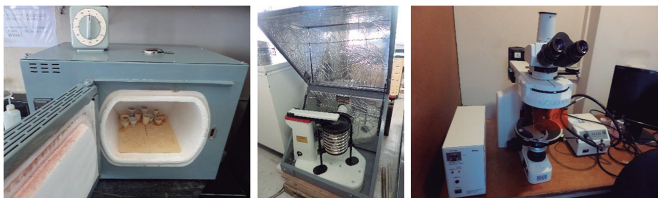
Figura 5.- Equipos de análisis en laboratorio a) Mufla eléctrica Thermolyne b) Tamizador eléctrico marca Tyler c) Microscopio petrográfico Nikon E600POL
