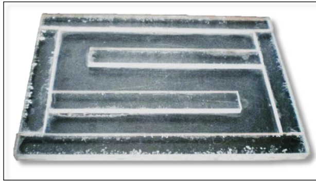
Figura 6. Cámara Bogorov para recuento de zooplancton.
