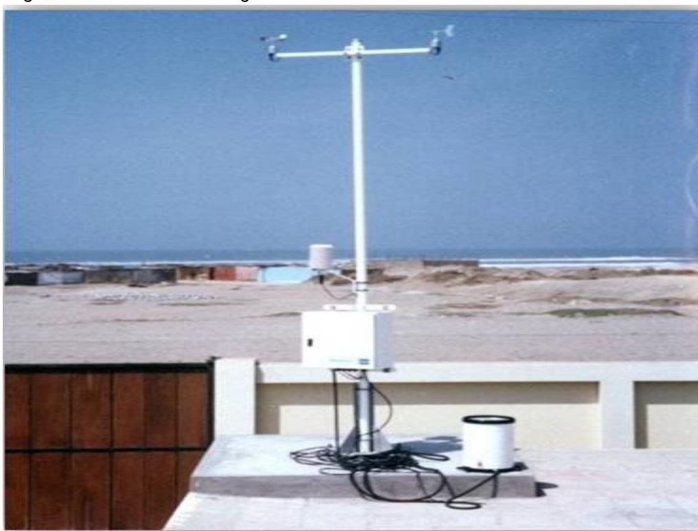
Figura 1: estación meteorológica automática del laboratorio costero Santa Rosa.
