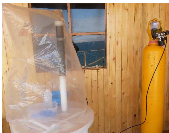
Figura 9. Utilización de glove bag, para evitar oxidación de las muestras en estado reducido conectada a una botella de gas nitrógeno.
