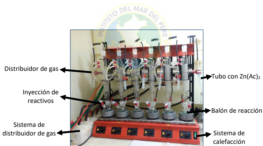
Figura 12 Sistema de destilación de AVS y CRS, puesto en funcionamiento en el laboratorio de estudios paleoambientales del departamento de geoquímica de la UFF.
