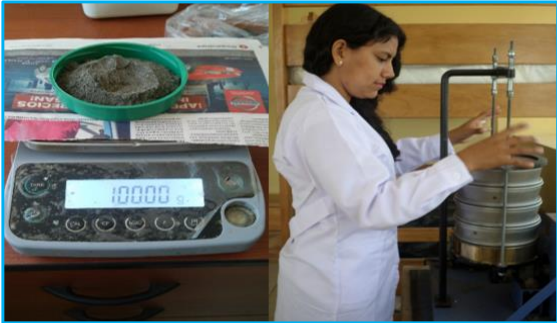
Figura 6. Peso y tamizado del sedimento para el análisis granulométrico, Salaverry – La Libertad.
