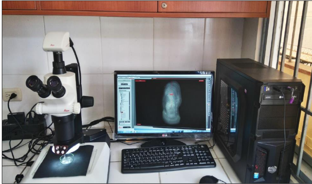
Fig. 4. Medición de radios de los anillos de crecimiento en otolito sagita de Paralichthys peruanus “coco” procedente de la pesca artesanal de la Región La Libertad de febrero a diciembre del 2014.
