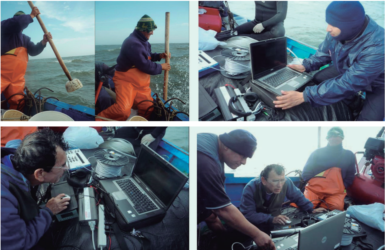
Figura 9.- Instalación del sistema acústico y toma de datos de ondas sonoras
