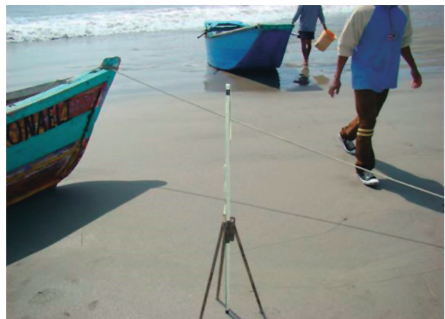
Figura 12.- Trípode con varilla 1 m
