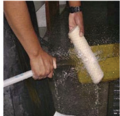
Figura 11.- Lavado: Filtros Cuno.
