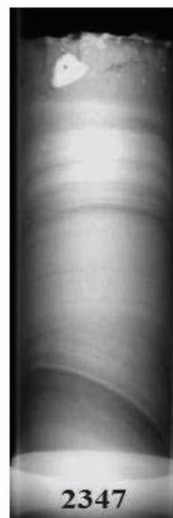
Figura 13.- Radiografía de rayos X del testigo PIGC030523-47, colectado en la estación 31 (438 m), mostrando la capa superficial colonizada por tubos de poliquetos ( Piromis sp.) sobre los sedimentos laminados.
