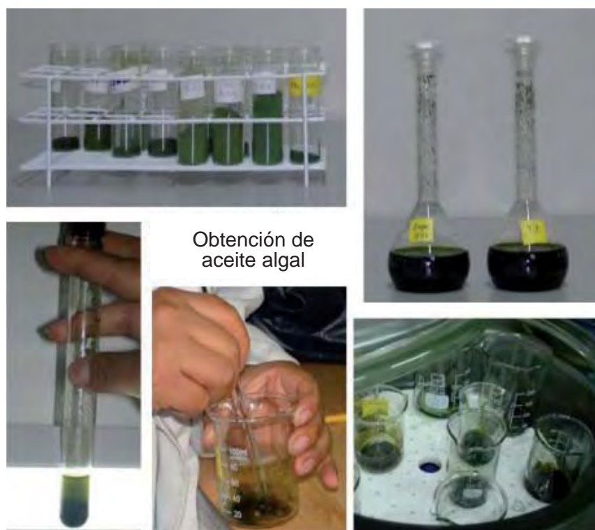
Figura 40.2.- Flujo de extracción de lípidos totales a partir de biomasa algal seca con el método modificado de Folch, 1956.
