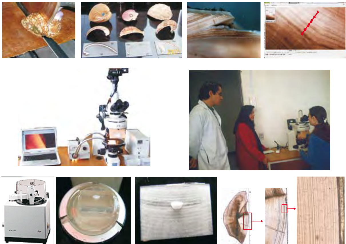
Figura 24.2.- Imágenes de proceso de corte: cortes de secciones de conchas, al microscopio y durante análisis de imágenes (superior). Microscopio petrográfico Nikon e investigadores del IMARPE y del IRD durante trabajo conjunto de estudios de microestructuras (centro). Equipo de corte de otolitos, otolito envuelto en resina y seccionado y corte obtenido del microscopio (abajo).
