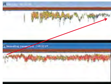
Figura 20.1.- Ecograma de un cardumen de anchoveta, a diferentes velocidades (Arriba a 8 nudos y abajo a 3,5 nudos).
