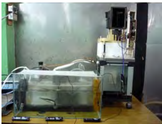
Figura 10.7.- Prueba de Temperatura Crítica Mínima en anchoveta peruana, utilizando un sistema de enfriamiento de agua de mar (chiller).
