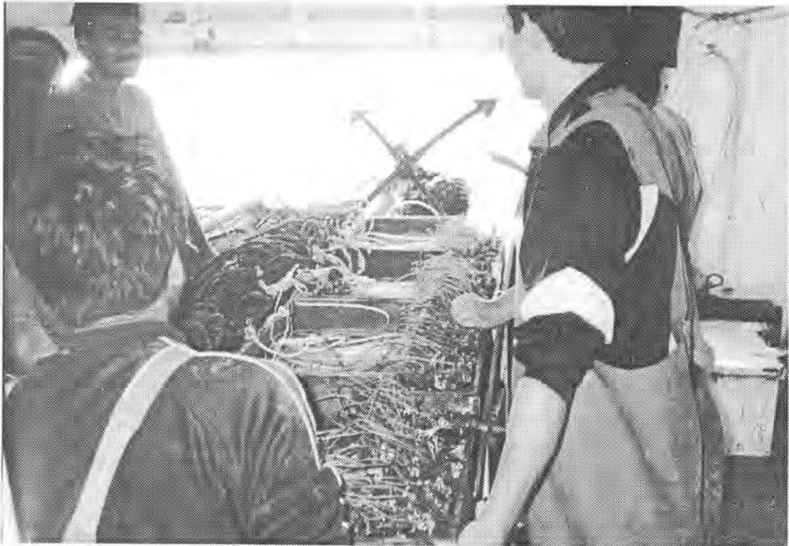
FIGURA 16. Preparación de cajas con el arte de pesca engarzado con barandillos, potalas y línea de retenida.
