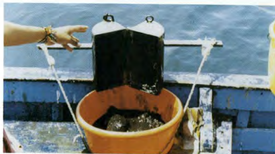
Muestra de bentos para evaluar la contaminación.
