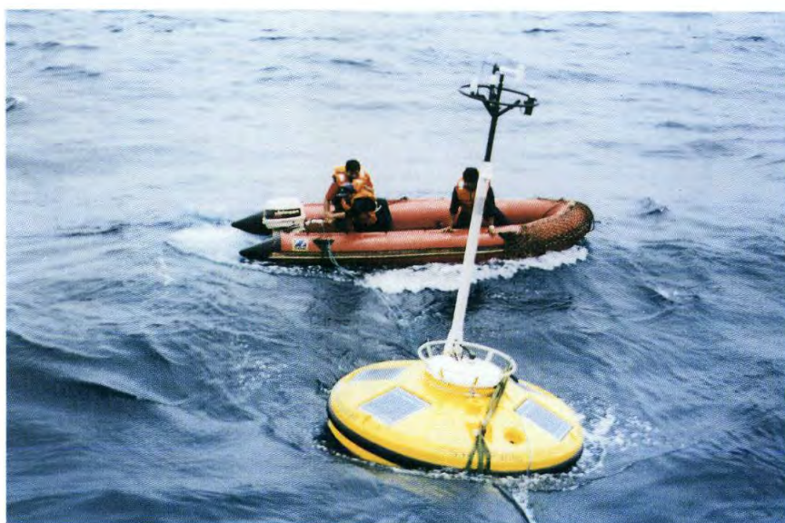
Instalación de una boya oceanográfica.
