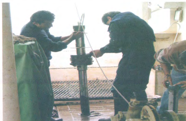
Muestreo exploratorio con sacatestigos de gravedad (izq.) y Sacatestigos de caja (Box Corer) tipo Soutar (der.).
