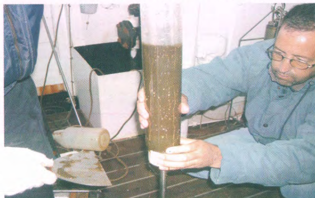
Obtención de testigos de gravedad y losa de sedimento del Box corer.
