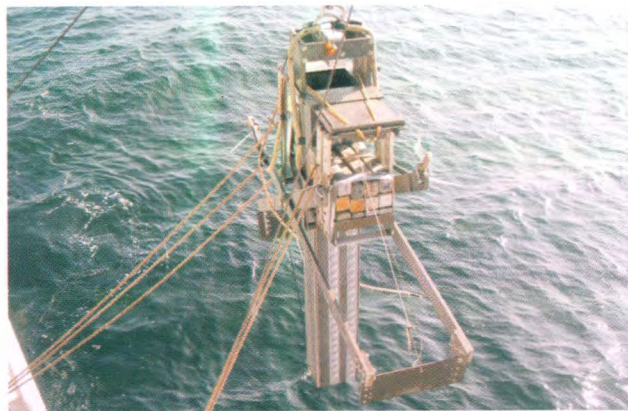
Muestreo exploratorio con sacatestigos de gravedad (izq.) y Sacatestigos de caja (Box Corer) tipo Soutar (der.).
