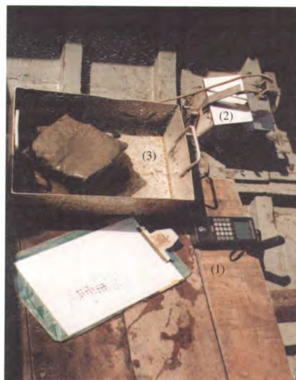
FIGURA 4. (1) GPS, (2) Draga Eckman y (3) muestra de sedimento extraída.
